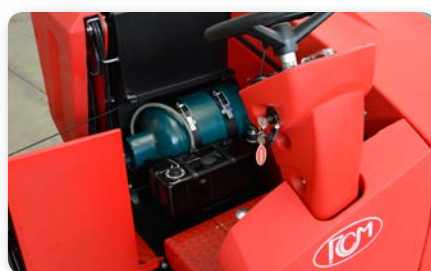
Impianto GPL LPG system Instalación de GLP
